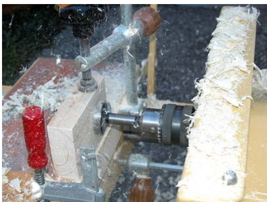
Bohren der Linsenhalterungen
